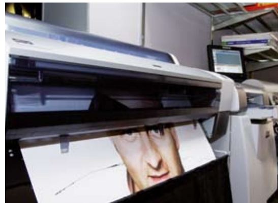
Die volle Arbeitsbreite von 111 cm wurde beim Druck der Porträts auf dem Epson Stylus Pro 9880 im Studio Pawlok ausgenutzt. Die Fotos wurden mit der Sinar Hy6 und einem 33 Megapixel-Sensor, dem Sinarback eVolution fotografiert
