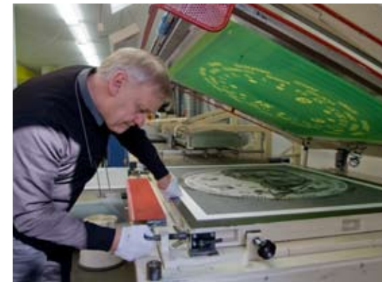
Grün schimmert oben das Sieb, durch das die Haftbrücke (Leim) auf den Inkjet-Druck aufgetragen wird. Nur so erreicht man im nächsten Arbeitsgang die gewünschte konturgenaue Verteilung der Goldblättchen
