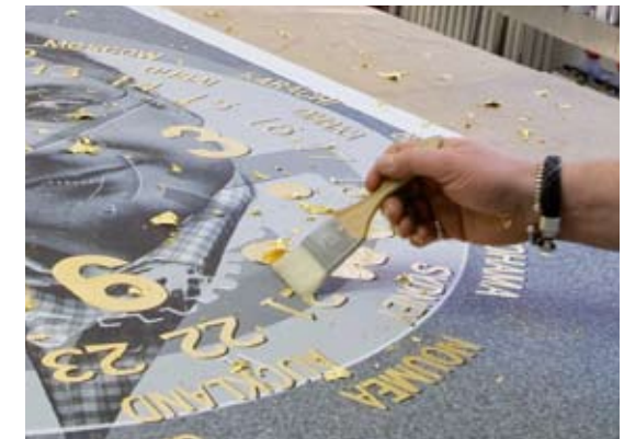
Per Siebdruck wurde die Haftbrücke konturgenau auf den großformatigen Print (Somerset Velvet) aufgebracht. In den noch feuchten Leim arbeitet Werner Pawlok dann mit dem Pinsel das Blattgold vorsichtig ein
